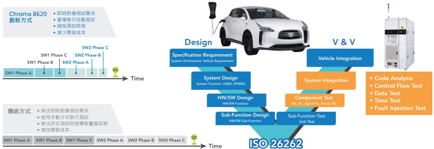
Chroma 8620具有獨立PLC監控系統，可即時監控系統軟體與功率設備運行狀態，當錯誤發生時，啟動保護機制及警告機制，避免設備及待測物之損傷。透過彈性架構軟體平台，載入CAN HS/FD、LIN之通訊文檔，結合即時系統、功率設備、量測設備及車輛數學模型對車載充電器/DC-DC轉換器進行Real-Time動態測試；在執行手動測試或自動測試過程中，可彈性編輯人機操作監控畫面及自動測試流程，其中，自動測試支援以ASAM XIL為介面之上層測試軟體，完成自動測試程序後，可自動產出測試報告，方便觀察測試變化及確認結果；測試過程中亦可記錄測試數據，以TDMS、CVS、Text的格式進行存取，利於分析測試結果。
