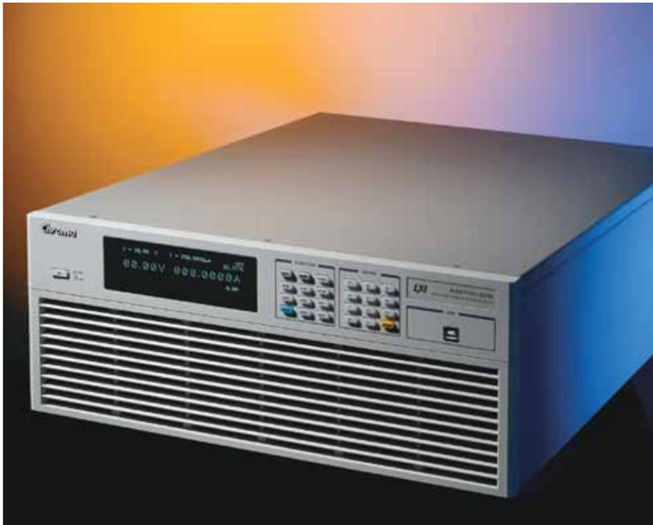
62075H-30N形は、シンクロトロン加速器内の電磁石電源システムに超高安定度直流電源として多くのユニークな利点を提供します。この電源の利点は、1.25mA/0.5時間および2.5mA/8時間の経時電流安定度、10mA以内の電流再現性、20ビットのDACと24ビットADCによる正確な設定と出力電流のリードバックが可能です。
