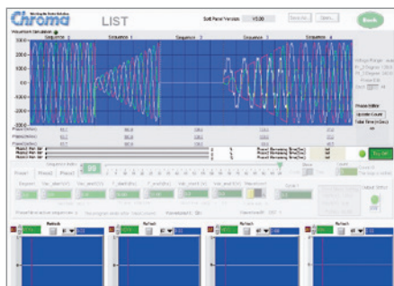
Programmierung der transienten Spannung
