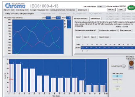
Spannungsharmonische und interharmonische Prüfung
