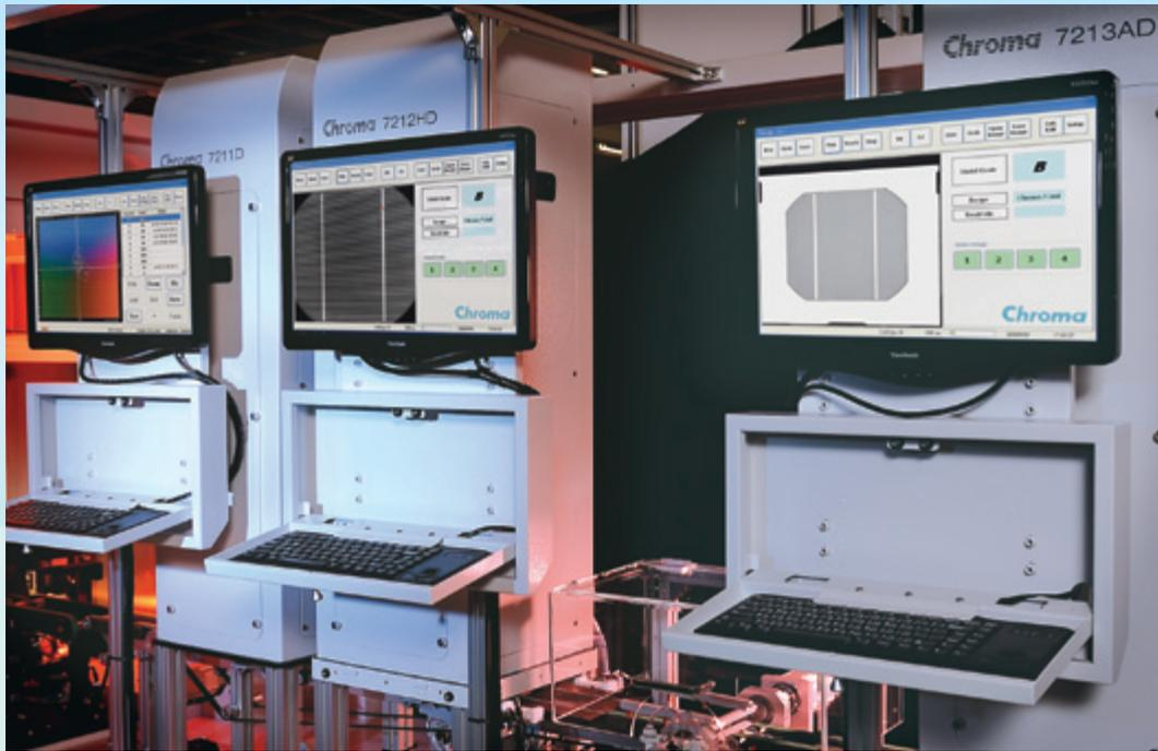
在眾多可以幫助光伏產業邁向"市電同價"的重要因素之中，光伏組件的可靠度是一個非常重要的關鍵因素。有些光伏組件安裝初期的失效原因常常來自於在光伏電池片階段的外觀不良，例如邊緣缺角，表層剝落，或者是鋁凸等。而這些瑕疵也就變成光伏電池片製造商在品質把關時候的一個非常重要的課題。因此，對於光伏模組的品質以及可靠度來講，硅片以及電池片的瑕疵檢驗就顯得相當重要。
