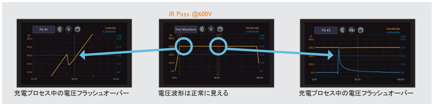
[図8] Chroma 11210ですべての不良製品のPD発生時の波形を記録
